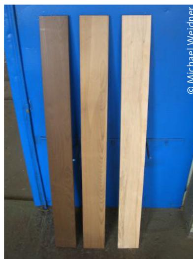
Thermoholz der Rotbuche im Vergleich (von rechts nach links): gedämpft, thermobehandelt bis ca.  $190^{\circ}C$ , thermobehandelt bis ca.  $200^{\circ}C$ .
