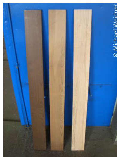
Thermoholz der Rotbuche im Vergleich (von rechts nach links): gedämpft, thermobehandelt bis ca. 190^{\circ}\text{C} , thermobehandelt bis ca. 200^{\circ}\text{C} .
